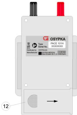
Abbildung 4: Zugang zum Batteriefach
